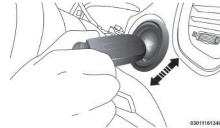
Procedimiento de arranque con batería del transmisor de entrada sin llave baja o agotada
