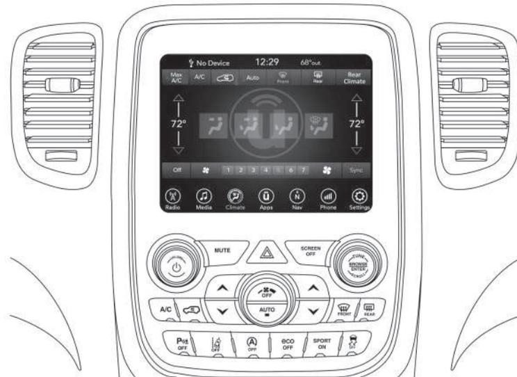
Controles de temperatura del Uconnect 4C/4C NAV con pantalla de 8,4 pulgadas
