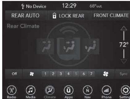
Controles de la parte trasera del Uconnect 4C/4C NAV del tablero ATC de la parte delantera con pantalla de 8,4 pulgadas
