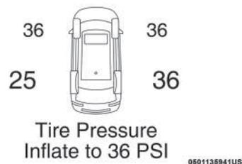
**Pantalla del monitor de baja presión de los neumáticos**
