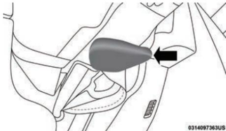
Palanca de inclinación/telescópica
