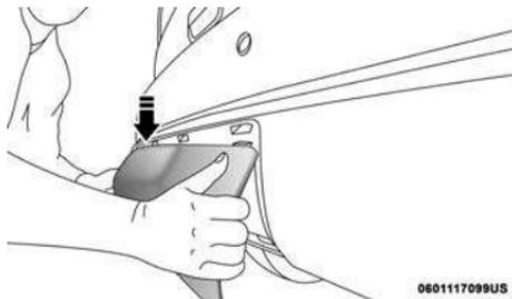
**Cubierta para el receptor del enganche**
