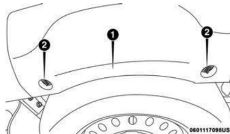
**Retenes de la cubierta para el receptor del enganche**
