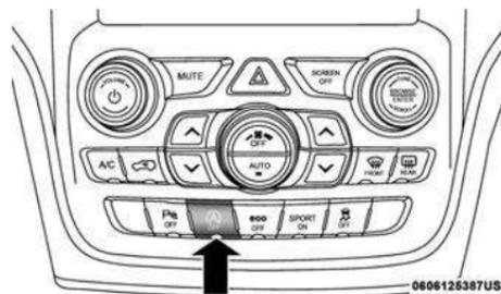
**Interruptor Off (Apagado) del sistema de DETENCIÓN/ARRANQUE**
