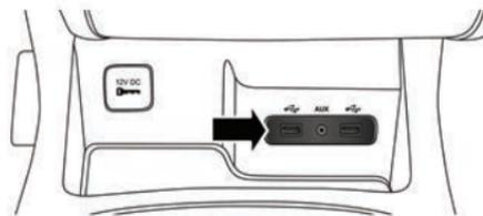
Concentrador de medios USB/AUX de la consola central integrada
