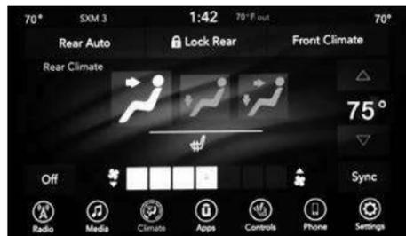
Controles de la parte trasera del Uconnect 4 del tablero ATC de la parte delantera con pantalla de 7 pulgadas
