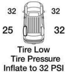
**Pantalla del monitor de baja presión de los neumáticos**
