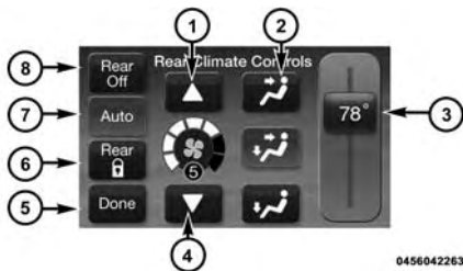
Botones de control de clima trasero en la pantalla táctil de Uconnect® 4.3
