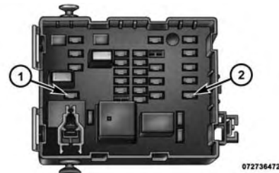
Fusibles de la toma de corriente
