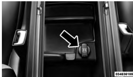
Toma de corriente de 12 voltios de la consola central
