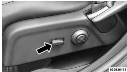
Interruptor del asiento eléctrico
