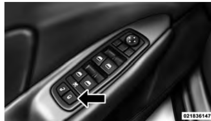
Ubicación del interruptor de bloqueo eléctrico de la puerta
