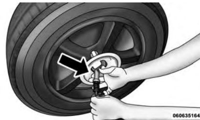
Instalación del cabrestante
