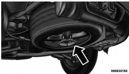
Rin instalado en el lugar del neumático de repuesto
