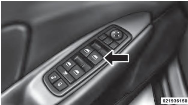
Interruptores de ventanas eléctricas
