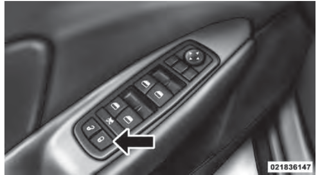
Interruptores de los seguros eléctricos
