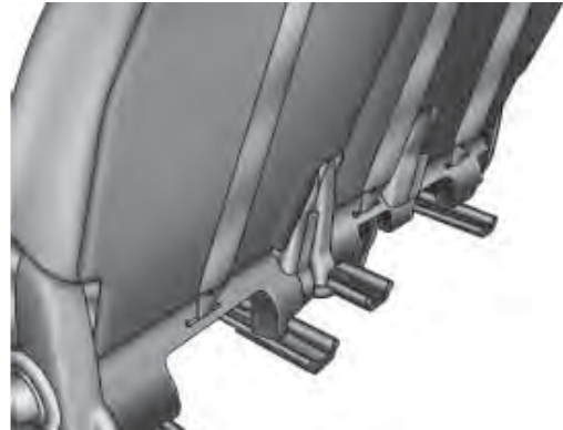
Montaje de la cinta al ancla trasera
